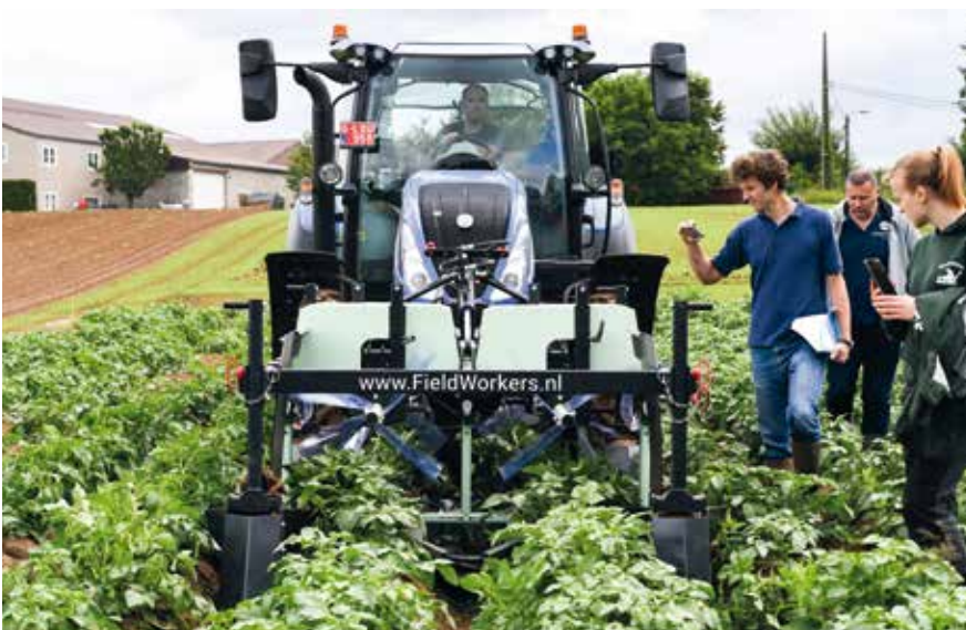
Abbildung 3: Demonstration des Colorado Beetle Catchers der Firma Fieldworkers (NL) im Versuch in Gembloux. (© FIWAP & CRA-W)
