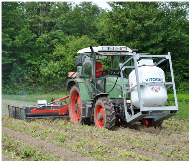
Сучасний випалювач з фронтальним резервуаром на гідравлічному приводі
