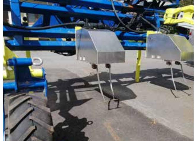
Abb. 12: Mit InRowHacken ist eine Regulierung der Beikräuter in der Kulturpflanzenreihe bei bestimmten Kulturen möglich.
