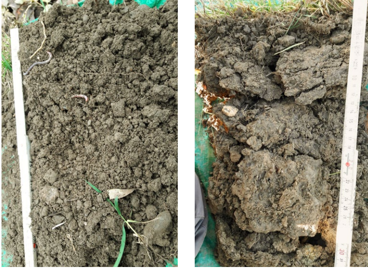
Comparaison de deux tests à la bêche de sols différents: à gauche, le sol sous le rang du verger agroforestier bio d'un score VESS de 1.0; à droite, le sol de l'inter-rang d'un verger conventionnel d'un score VESS de 3.6.
